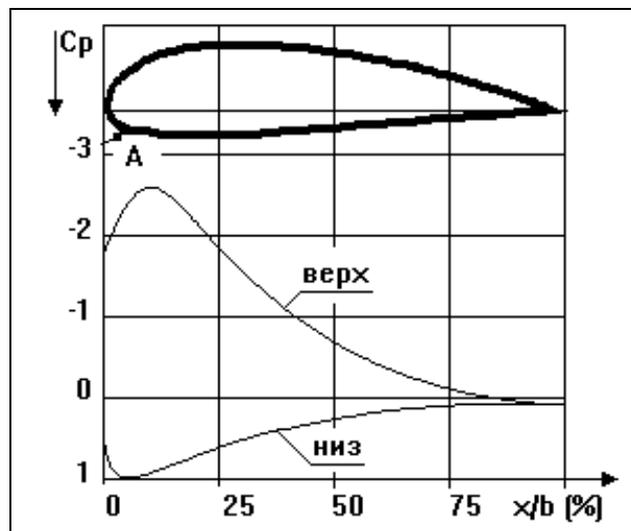
Рис. 37. Эпюры распределения давления по поверхности профиля.
