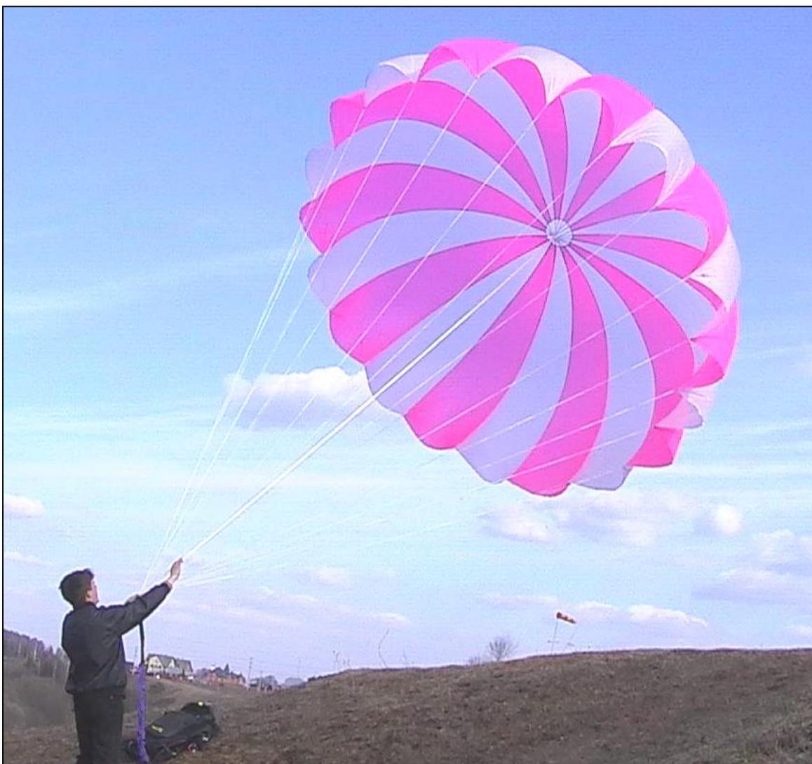
Рис. 96. Спасательный парашют «Plus-31» фирмы «Junkers profly».
