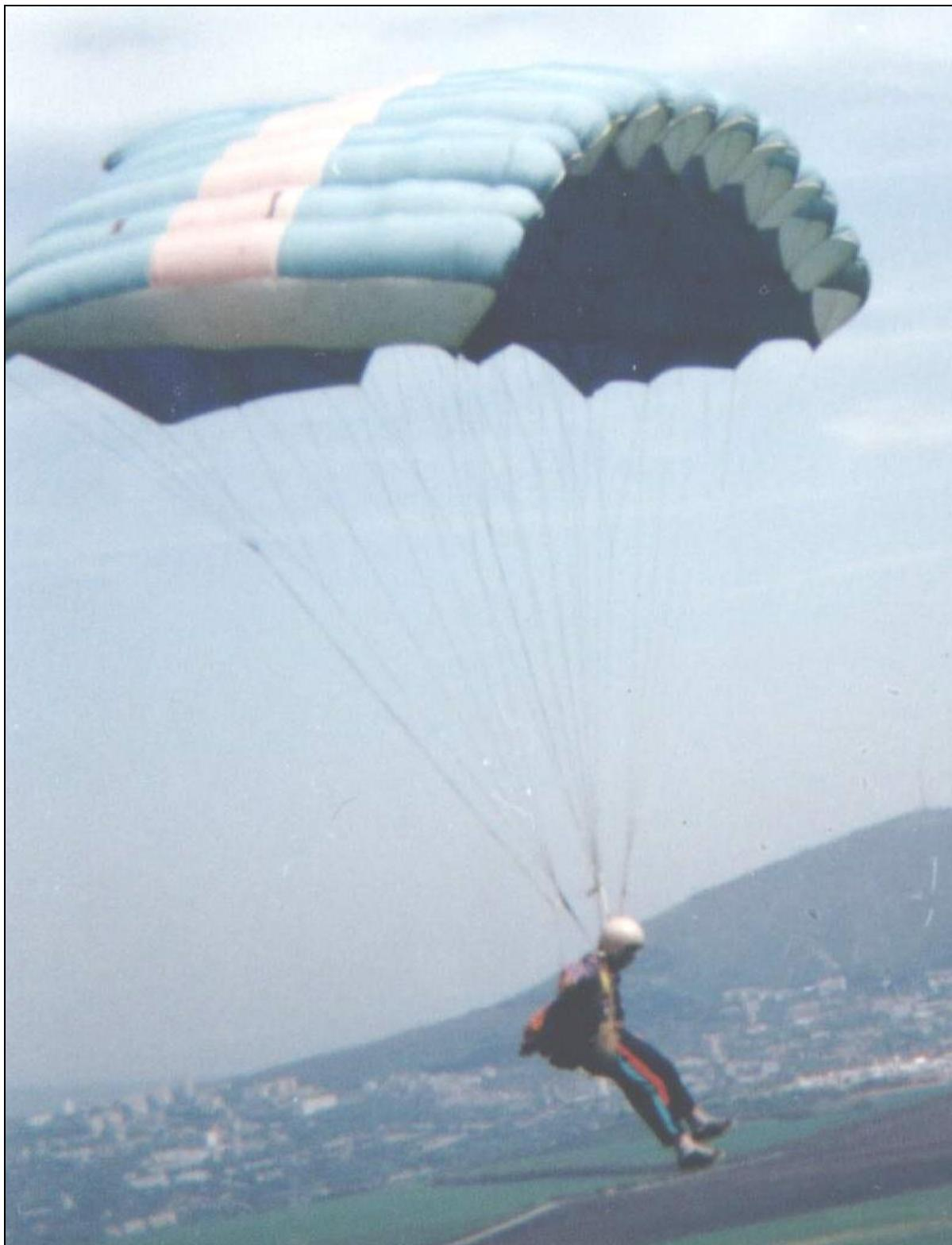
Рис. 1. В полете СППЗ0 - один из первых Российских парапланов. Аппарат был разработан в отделе спортивной техники НИИ парашютостроения в 1989 году.
