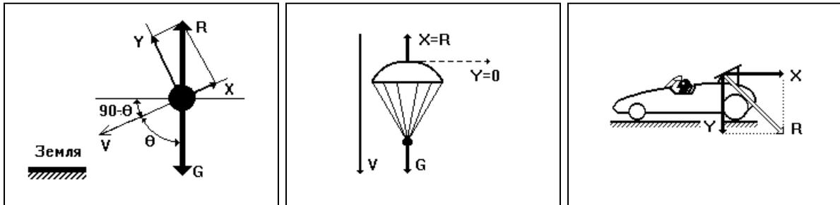
Рис. 15. Разложение  $R$  на  $Y$  и  $X$ .
