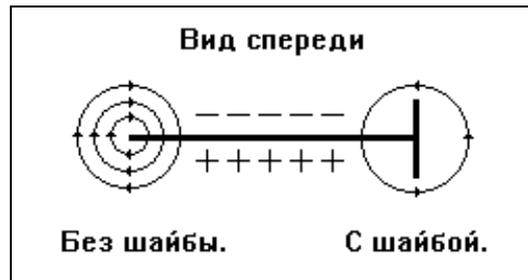
Рис. 43. Уменьшение индуктивного сопротивления с помощью концевых шайб.
