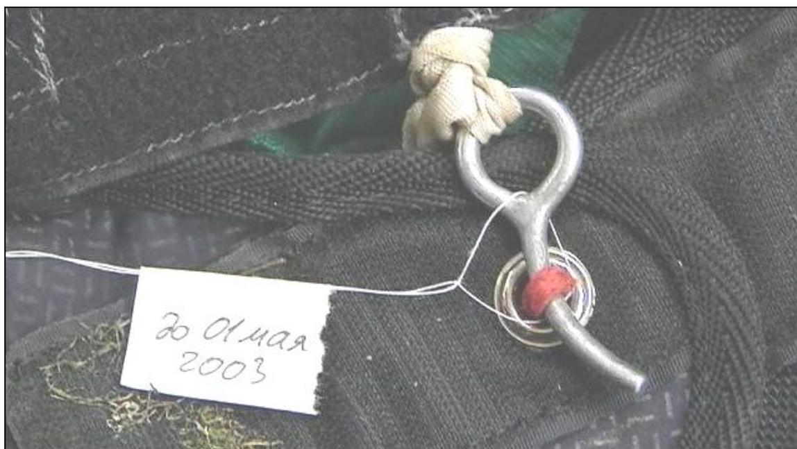
Рис. 103. Метка с датой очередной переукладки парашюта.
