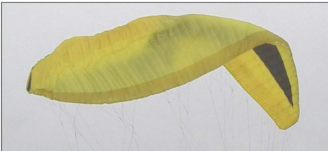
Рис. 65. Начало сложения крыла парaplана по передней кромке.
