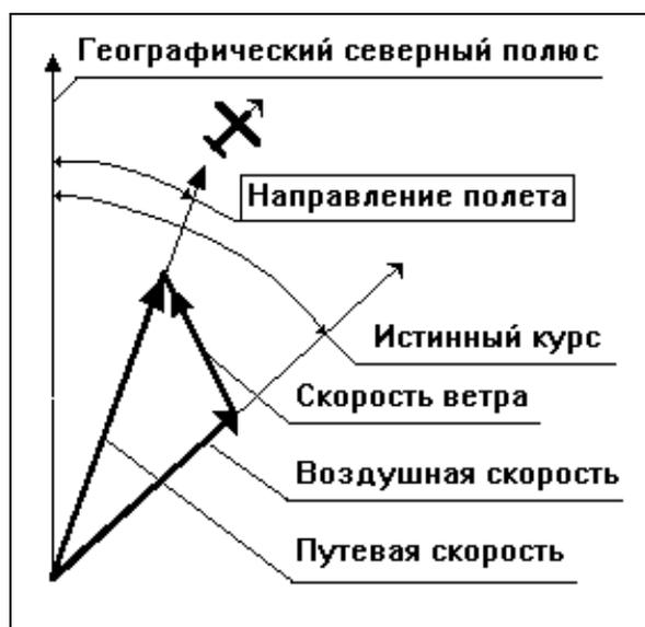
Рис. 105. Треугольник скоростей. Путевая скорость ЛА равна сумме воздушной скорости и скорости ветра.
