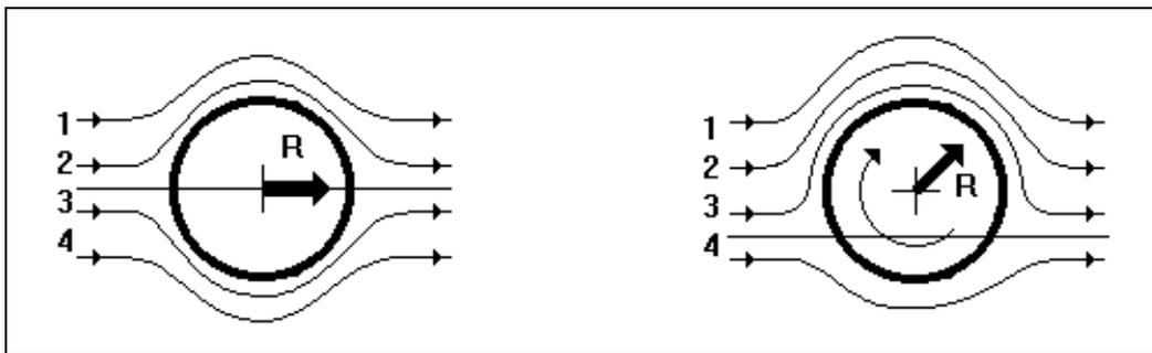
Рис. 45. Схемы обтекания невращающегося и вращающегося шара.
